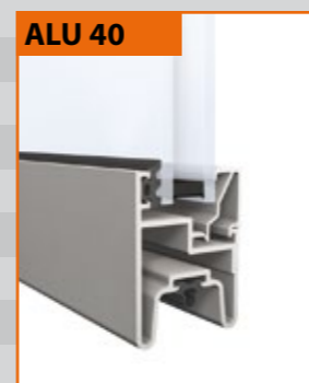
ALU 40 Panorama-Tor 40 mm Plexiglas-Doppelscheiben Optical 20 mm (4-12-4 mm)
