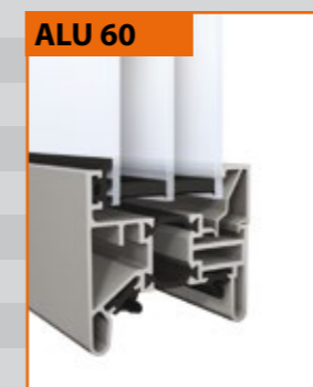
ALU 60 Panorama-Tor 60 mm Plexiglas-Dreifachscheiben Optical 40 mm (4-14,75-2,5-14,75-4 mm)
