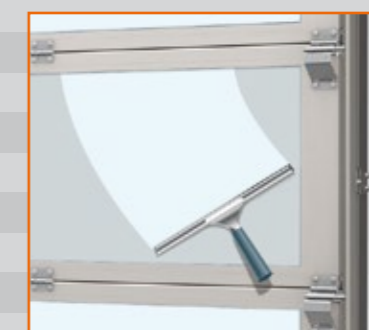
ALU 60 Panorama-Tor 60 mm Plexiglas-Dreifachscheiben Optical 40 mm (4-14,75-2,5-14,75-4 mm)
